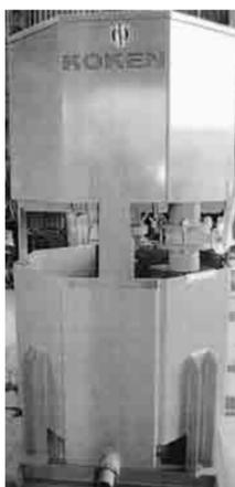
●グラウトミキサーは、混合物に対し活発な攪拌効果で材料の分離が極めて少なく、流動性・均質性に富むモルタル・セメントミルク等を作ることができます。
